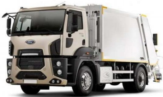
Рисунок 16 Смітєвоз заднього завантаження СВ-505.1 на шасі 4x2 FORD TRUCKS 1833 DC
